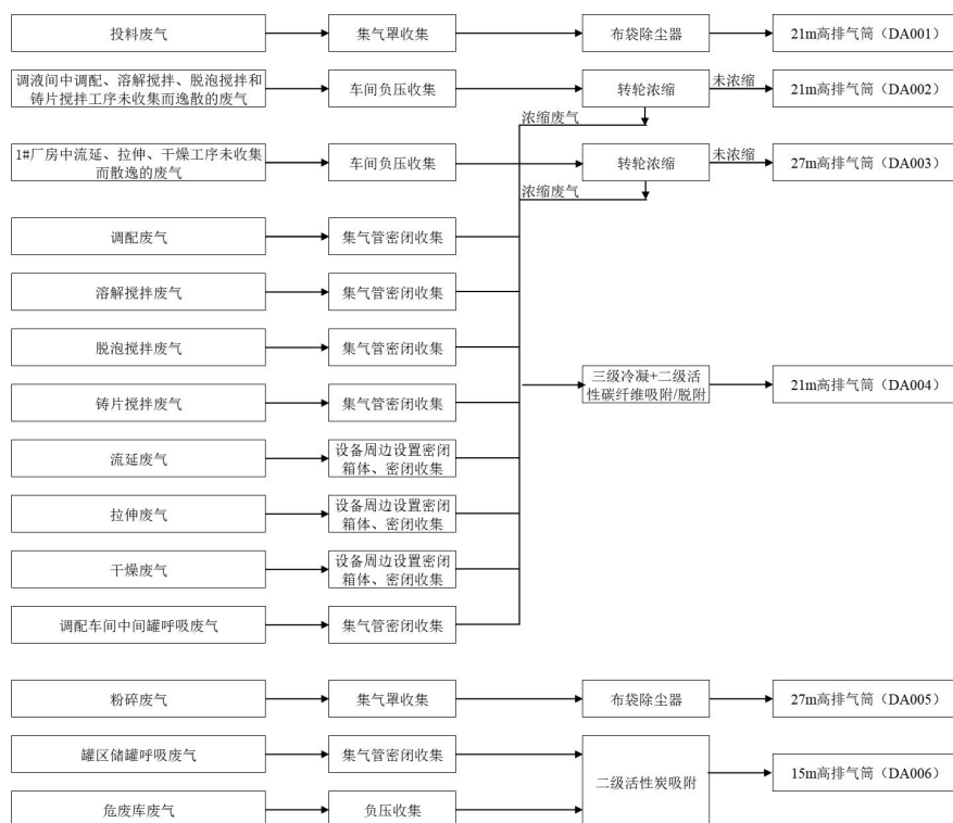
图 7.2.3-1 废气收集处理系统示意图
