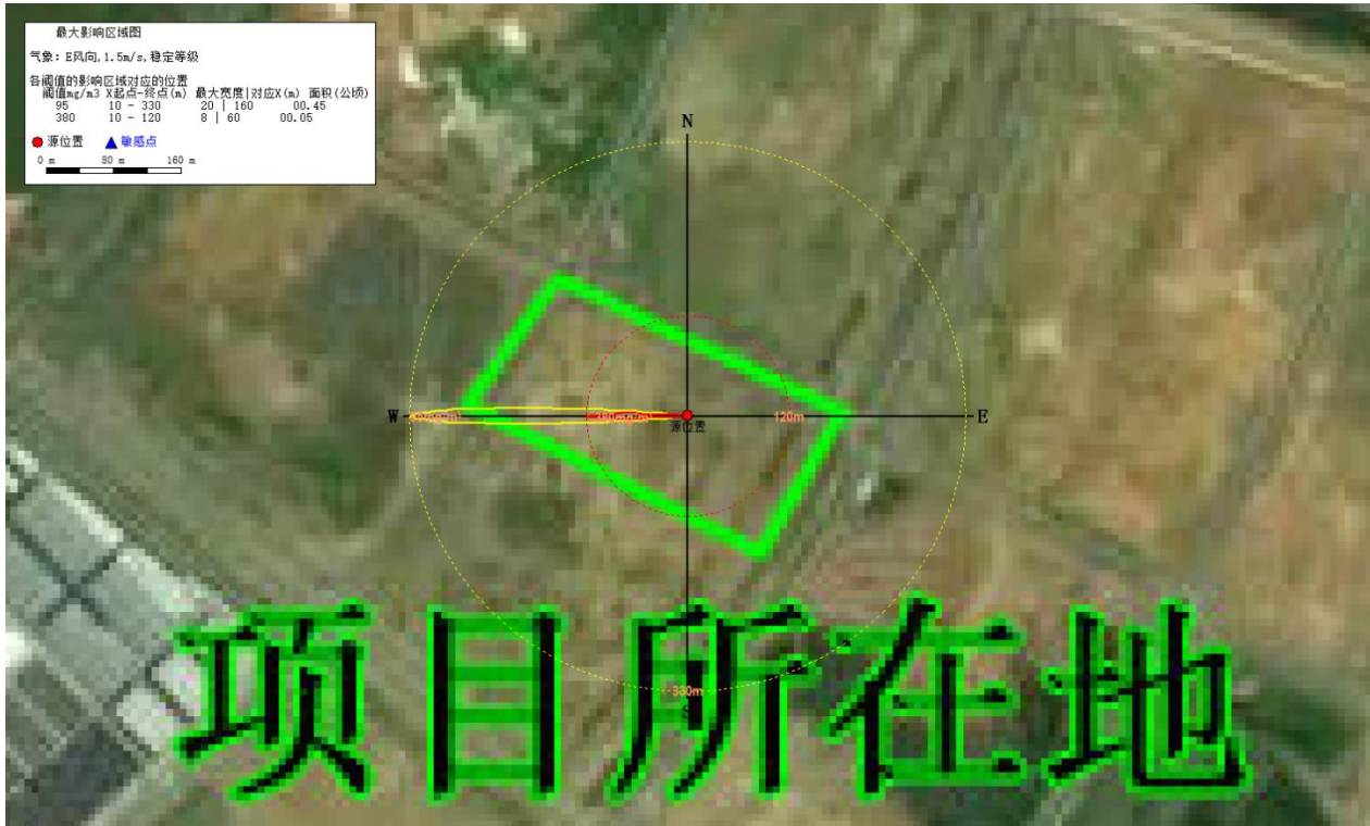
图 6.7.1-10 最不利气象条件下 CO 预测浓度达到不同毒性终点浓度最大影响范围分布图
